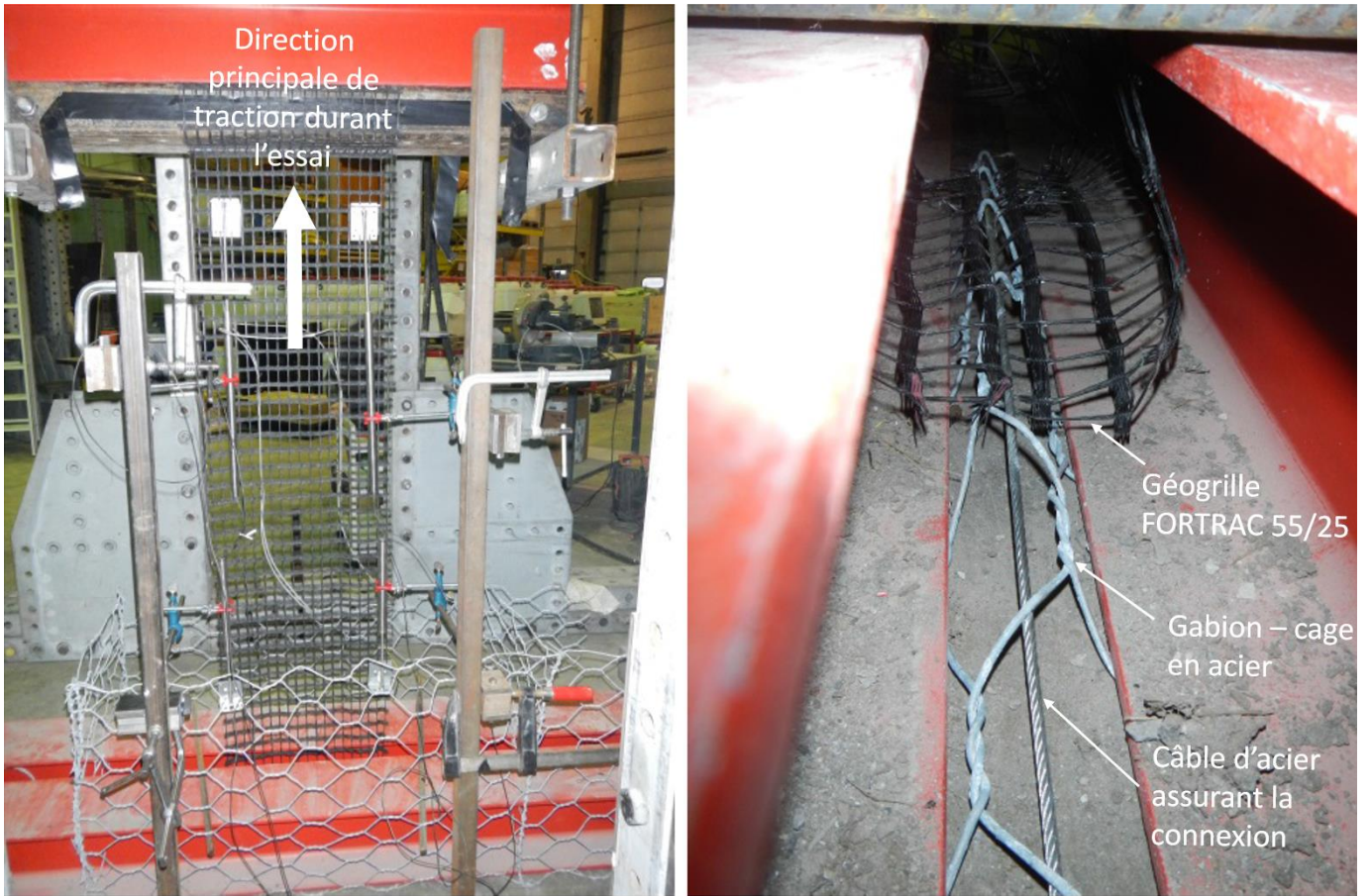
Figure 13. Essai de traction réalisé dans les laboratoires de manière à tester la résistance de la connexion « géogridde – gabion ».
